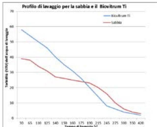
La curva mostra il confronto di consumo di acqua durante il controlavaggio tra un filtro con riempimento a sabbia ed un filtro con riempimento a Biovitrum Ti.
